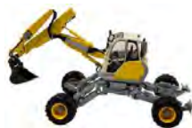
Une pelle araignée réalisera la plateforme de travail au pied du mur de la rue des Fantasques
